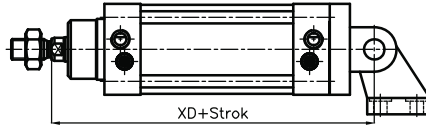
Eklem yer bağlantı Swivel flange mounting with clevis foot
